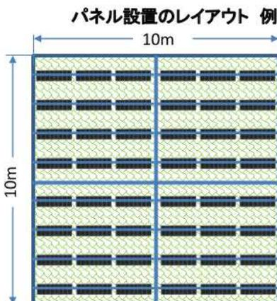
**遮光率**は農地を上から見た時に、太陽光パネルの面積の合計を、架台を設置した土地の面積で割った数値(%)です。下部で栽培する作物にもよりますが、遮光率を30%前後にすることが多く、またパネルは光や雨ができるだけ均等に当たるように幅の狭いものが推奨されています。
